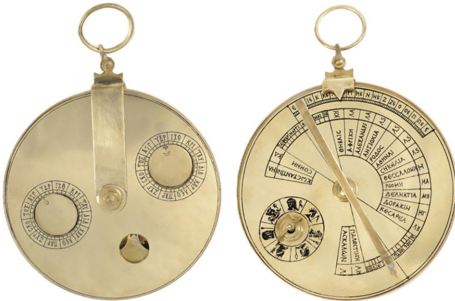
Εικόνα 73 Αρχαίο ηλιακό ρολόι ημερολογιακός μηχανισμός, Βυζαντινής περιόδου γύρω στο 400-500 μ.Χ. Ρυθμίζεται για διάφορες πόλεις Αλεξάνδρεια, Αντιόχεια, Ρόδο, Αθήνα, Σικελία Θεσσαλονίκη, Ρώμη, Δαλματία, Καισάρεια. Βρίσκεται στο Μουσείο Επιστημών Λονδίνου. Ανακατασκευή: Διονύσης Κριάρης.
