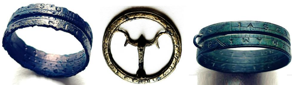
Εικόνα 85 Τρία φορητά ηλιακά ρολόγια από την Αγγλία. Δύο δακτυλιοειδή και ένα επίπεδο (μέση). Έχουν διαμέτρους γύρω στα 3,5-4 cm. Λειτουργούν σε διάφορες εποχές του έτους. Ρυθμίζονται για την ημερομηνία. Το πρώτο και το δεύτερο από αριστερά βρέθηκαν στο βυθό της θάλασσας στα νησιά Isles of Scilly στην Αγγλία, στο ναυάγιο του πλοίου HMS Association (1697) που βυθίστηκε το 1707 με 800 ανθρώπινες απώλειες. Το δεξιό βρέθηκε στην ύπαιθρο, κοντά σε ρωμαϊκή οδό. Συλλογή παλαιών επιστημονικών οργάνων του κ. Ευάγγελου Κ. Παυλόπουλου
