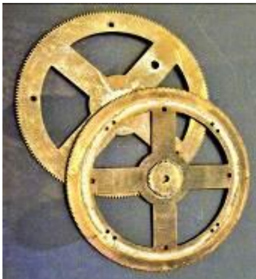
Εικόνα 23 Γρανάζια από την πρώτη ανακατασκευή του Μηχανισμού που έφτιαξε ο Ι. Θεοφανίδης, 1930
