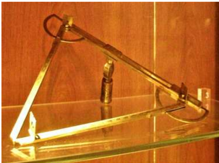
Όργανο της ακριβούς μέτρησης των θέσεων των άστρων με μεταβλητό τρίγωνο που ανήκε στον Τύχωνα Βράχε.
