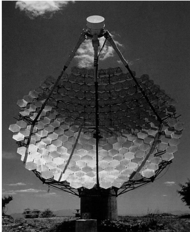
Σχήμα 2.8 : Ο ανιχνευτής ακτίνων γ πολύ υψηλών ενεργειών WHIPPLE στην έρημο της Αριζόνα.
