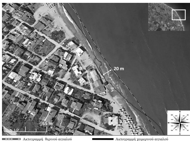
Σχήμα 5: Ακτογραμμή θερινού και χειμερινού αιγιαλού στο Βόρειο τμήμα του δέλτα: κατοικίες εντός της σύγχρονης παραλιακής ζώνης, σε θέση μεταξύ των τομών 8 και 9, απειλούνται από τις εποχιακές μεταβολές του πλάτους της (~20 m) (Πηγή: Google Earth, 06/2013).
