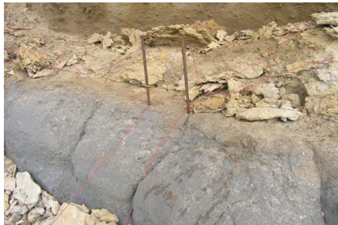
Εικόνα 3.28: Μέτρηση ειδικής αντίστασης στο σχηματισμό των πλειοκαινικών μαργών (θέση Is_m ).
