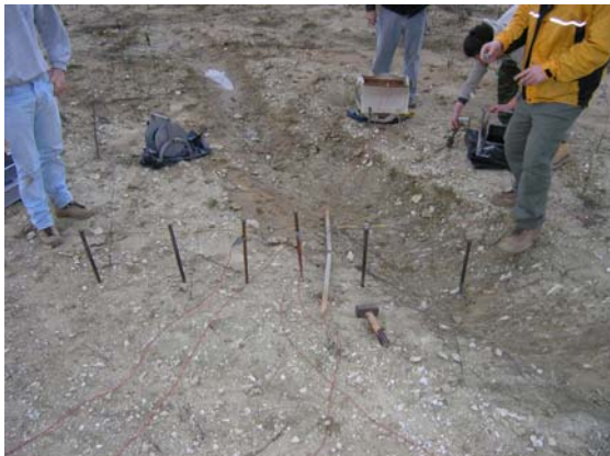
Εικόνα 3.30 α: Μέτρηση της ειδικής αντίστασης στις κατωπλειοκαινικές μάργες, παράλληλα με τη διεύθυνση των διακλάσεων (θέση S49 ).
