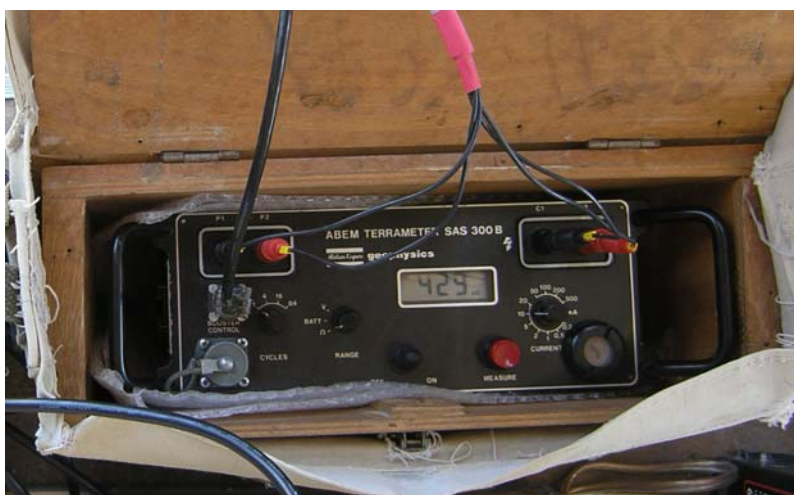
Εικόνα 3.22: Η γεωηλεκτρική συσκευή Terrameter SAS 300B.
