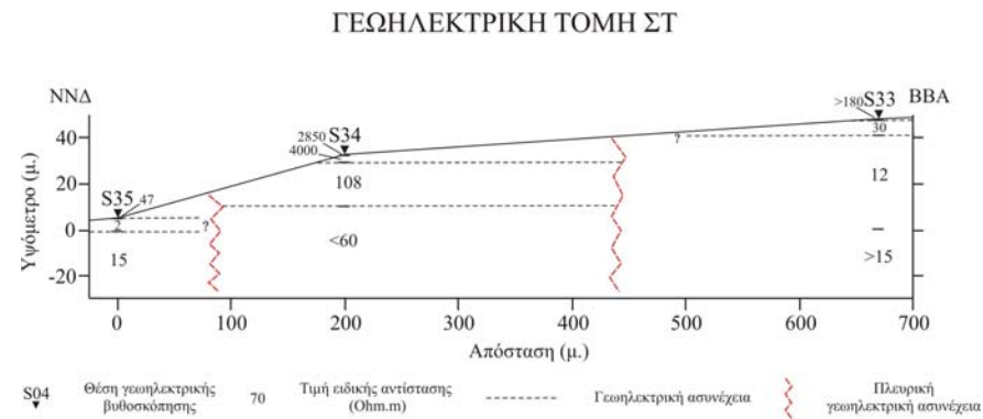
Εικόνα 3.54: Γεωηλεκτρική τομή ΣΤ, σε κλίμακα 1:2.
