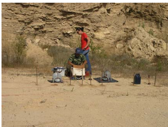
Εικόνα 3.26α: Μέτρηση της ειδικής αντίστασης στις παλαιές θίνες (θέση S30).
