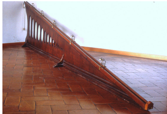
Σχήμα 2: Σύγχρονη ανακατασκευή του κεκλιμένου επιπέδου που χρησιμοποίησε ο Γαλιλαίος. Τα καμπανάκια σε συγκεκριμένες θέσεις κατά μήκος του επιπέδου ίσως να είχαν χρησιμοποιηθεί από το Γαλιλαίο προκειμένου να μετράει με τα δοχεία νερού το χρόνο.
