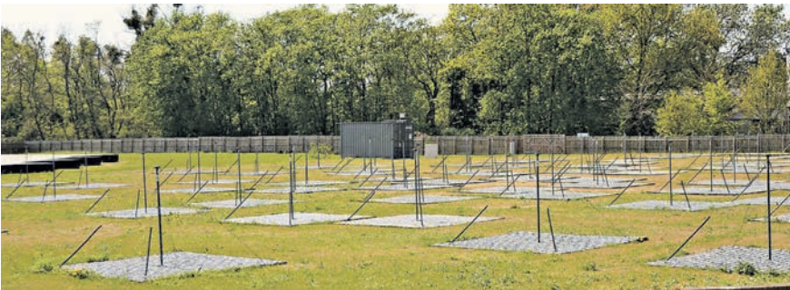
Δίπλω, μερικά από τα παραβολοειδή κατόπτρα που αποτελούν το ραδιοτηλεσκόπιο ALMA (Atacama Large Millimeter Array) στη Χιλή. Στην πρώτη εικόνα πάνω διακρίνεται ο σταθμός LOFAR στην Ουσάλα της Σουηδίας και κάτω άποψη του ίδιου σταθμού στο Πότσνταμ της Γερμανίας. Διακρίνονται οι κεραίες που αποτελούν τους ανιχνευτές των ραδιοκυμάτων.
