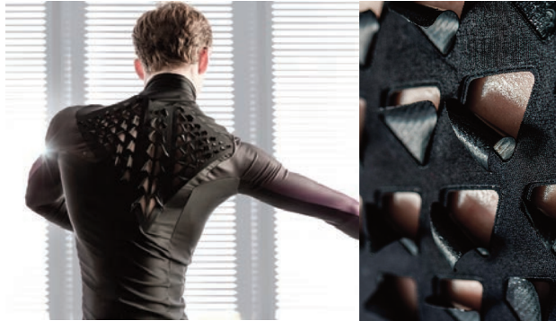
Εικόνα 4: Αριστερά, η στολή Bio-skin Clothing που «ανανέει» με το άνοιγμα οπών, κατασκευασμένη από το Tangible Media Group σε συνεργασία με τη New Balance. Δεξιά, λεπτομέρεια του υφάσματος
