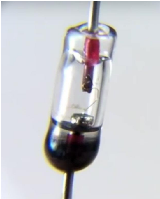
Δίοδος Γερμανίου επαφής μετάλλου– ημιαγωγού
