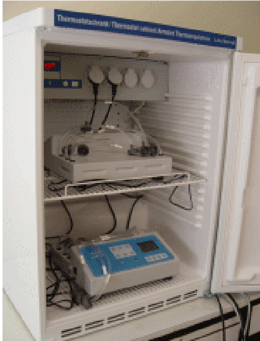
Εικ. 6 Θάλαμος επώασης όπου έχουν τοποθετηθεί δύο συσκευές BODTrack (χωρίς δείγματα), για τον μανομετρικό προσδιορισμό του BOD.
