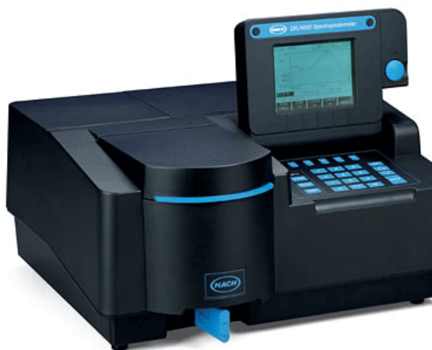
Εικ. 5 Εργαστηριακό φασματοφωτόμετρο που χρησιμοποιείται για τον προσδιορισμό δεκάδων φυσικοχημικών παραμέτρων φυσικών νερών και υγρών αποβλήτων με χρήση αντιδραστηρίων.
