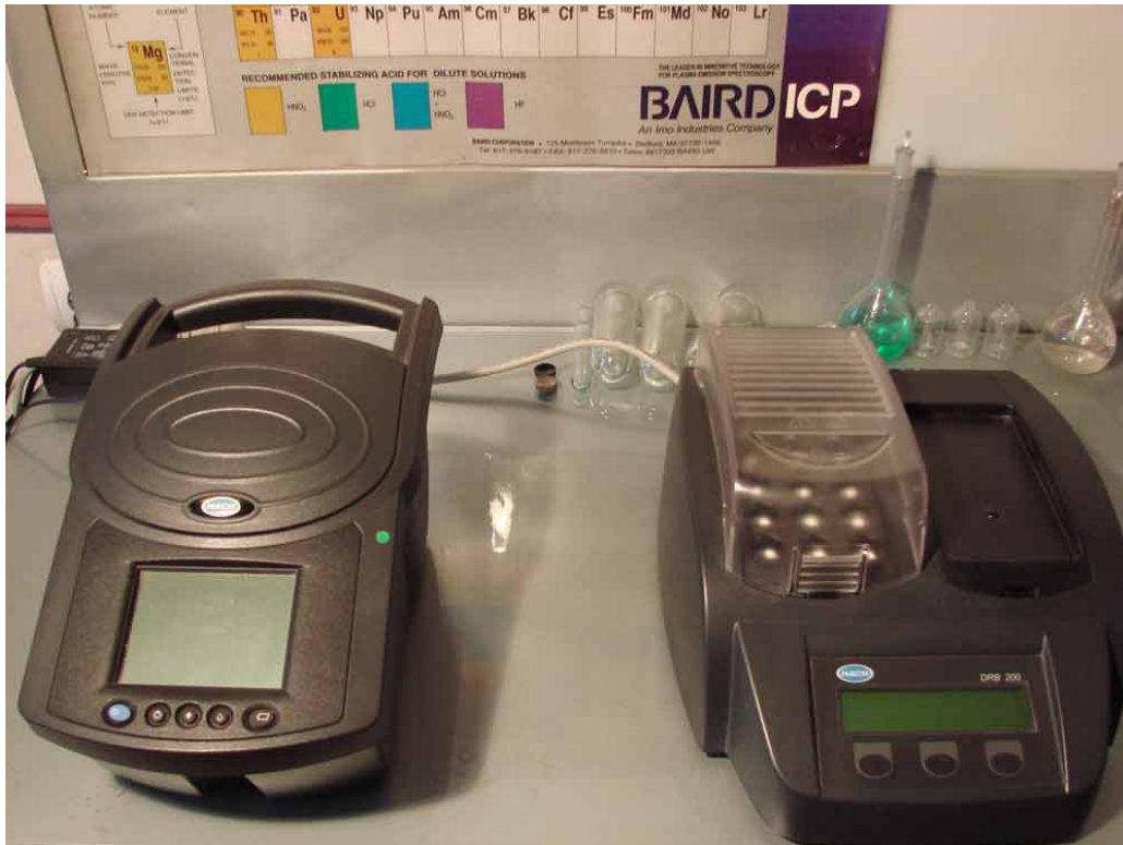
Εικ. 9 Συσκευή πέψης (δεξιά) και φορητό φασματοφωτόμετρο (αριστερά) που χρησιμοποιούνται για τον προσδιορισμό του COD και του TOC
