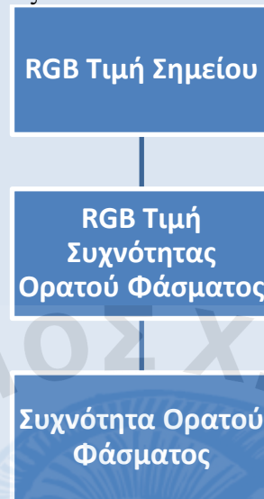
Σχήμα 4: Οι ενέργειες δια των οποίων μετατρέπουμε τις RGB τιμές για το χρώμα κάθε σημείου (pixel) μιας εικόνας σε συχνότητες του ορατού φάσματος.
