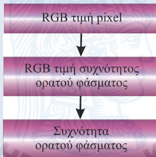
Σχήμα 6: Οι ενέργειες δια των οποίων μετατρέπονται οι RGB τιμές για το χρώμα κάθε σημείου (pixel) μιας εικόνας σε συχνότητες του ορατού φάσματος.
