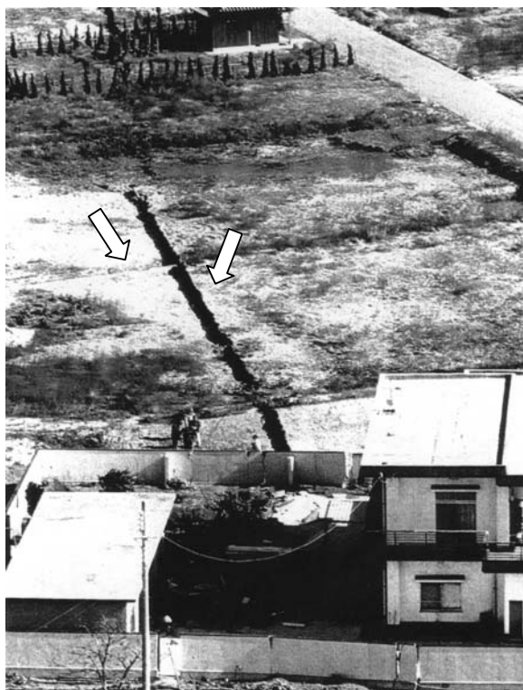
Εικ. 3 Ταυτόχρονη εμφάνιση ανάστροφου σεισμικού ρήγματος και ρευστοποιήσεων κατά το σεισμό του Kobe (βέλη).
