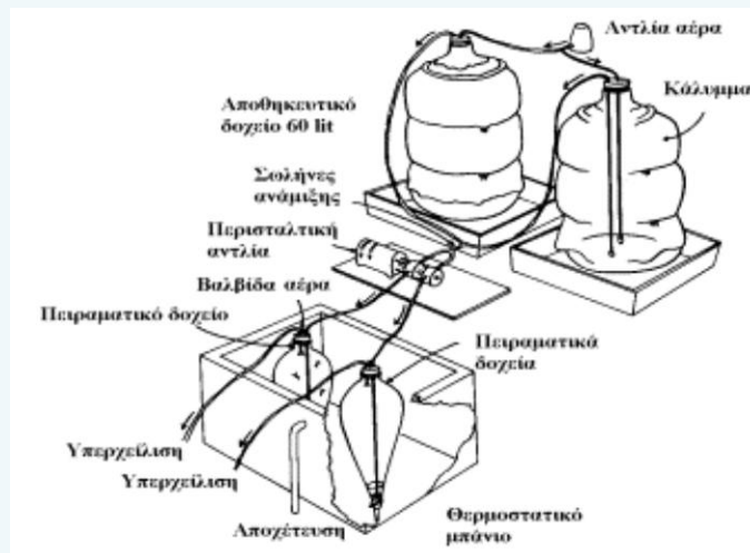
Σχήμα 20. Αναπαράσταση συστήματος συνεχούς ροής, σε καλλιέργειες πλαγκτού.
