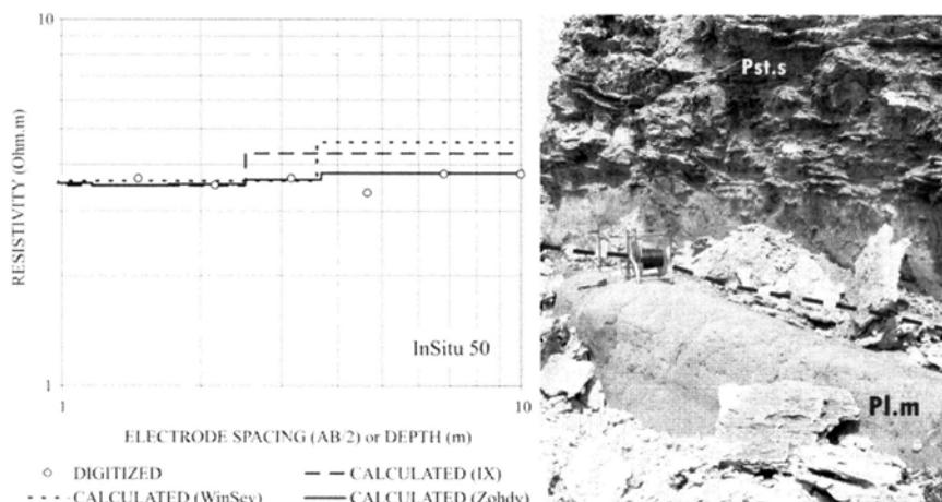
Εικόνα 3. Θέση επιφανειακής εμφάνισης μαργών [Pl.m] (δεξιά) και αποτελέσματα τη διεξαχθείσας «in situ» διασκόπησης VES 50 (αριστερά).
