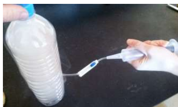
Εικόνα 2: Από το πλάι του μπουκαλιού γεμίζουμε τη σύριγγα με καπνό.
