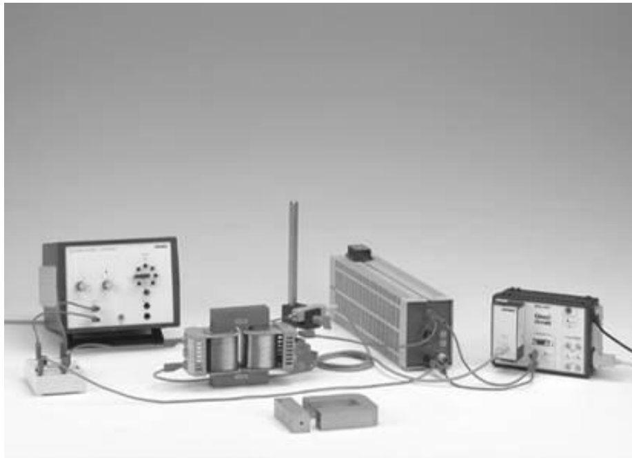
Εικόνα 1: Πειραματική διάταξη της μέτρησης της μαγνήτισης σιδήρου
