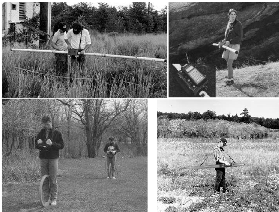
Εικόνα 6.21. Άνω: Γεωαγωγιμόμετρο Geonics EM31 σε ώρα εργασίας. Κάτω Α-ριστερά: Γεωαγωγιμόμετρο Geonics EM34 σε διαμόρφωση ΚΟΕ. Κάτω Δεξιά: Γεωαγωγιμόμετρο GSSI GEM-300 σε διαμόρφωση ΟΟΕ.
