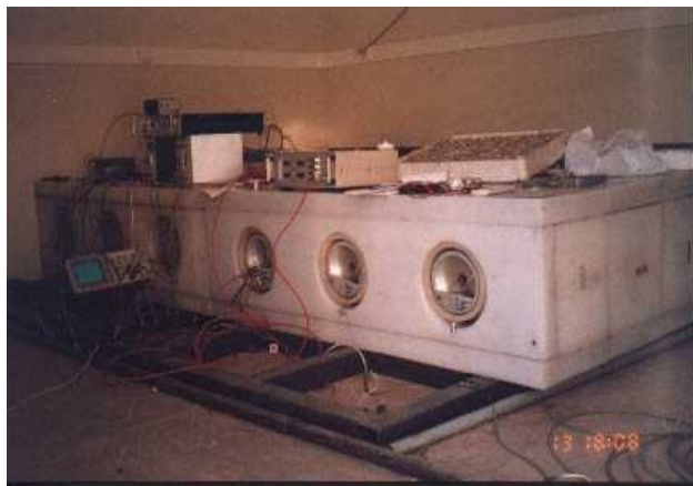
Σχήμα 1. Η ανιχνευτική διάταξη του σταθμού κοσμικής ακτινοβολίας του Πανεπιστημίου Αθηνών.
