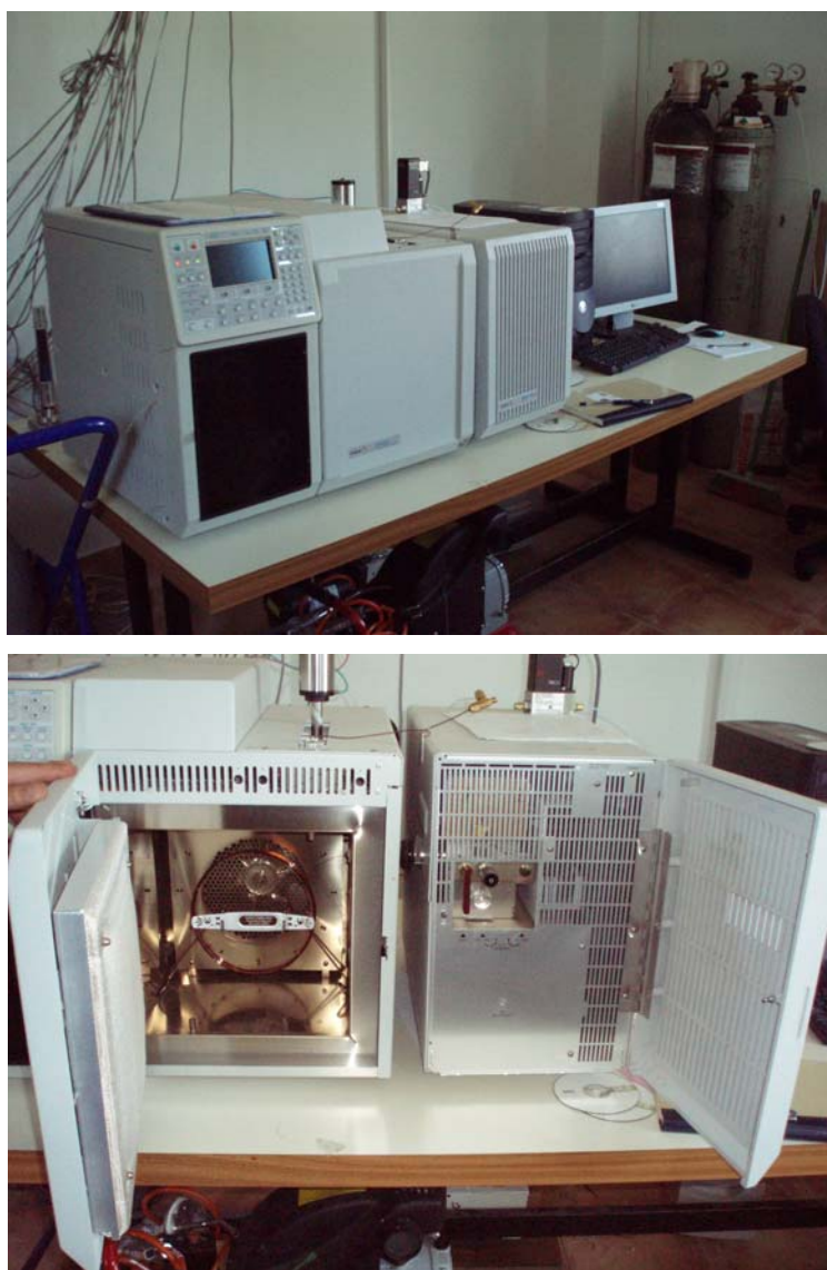
Εικόνα 5.1: Σύστημα GC-MS του Πανεπιστημίου Αθηνών. Στην κάτω φωτογραφία διακρίνεται η χρωματογραφική στήλη εντός του φούρνου στα αριστερά.
