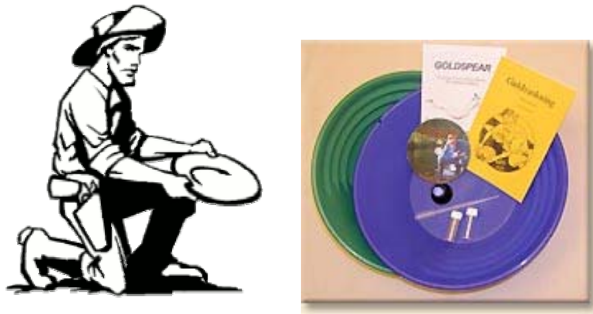
Εικόνα 2.3: Εξοπλισμός υδρομηχανικού εμπλουτισμού σε διασκοπίσεις ιζημάτων ρεμάτων.
