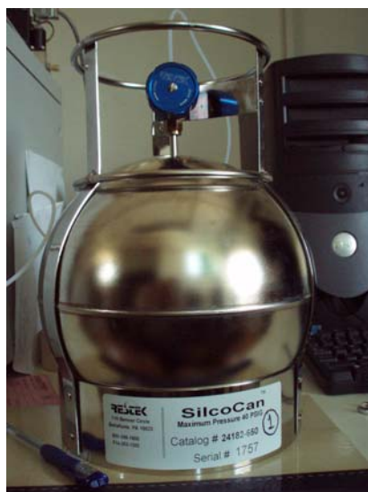
Εικόνα 5.5: Μεταλλικό κάνιστρο συλλογής δείγματος αεροζόλ για ανάλυση με GC-MS.
