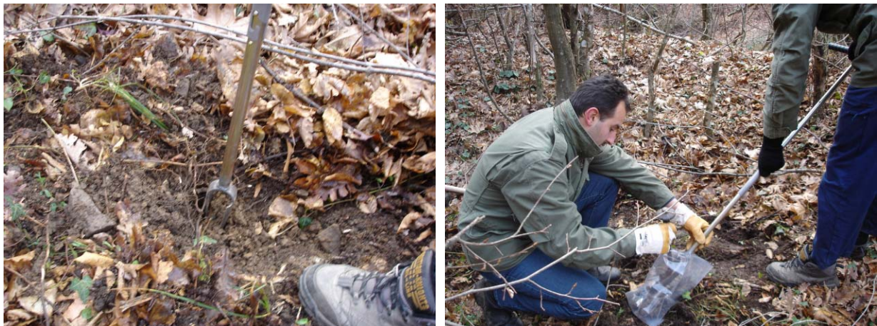
Εικόνα 2.6: Λήψη και συλλογή δειγμάτων επιφανειακού εδάφους με χειροκίνητο γεωτρήπανο (auger).
