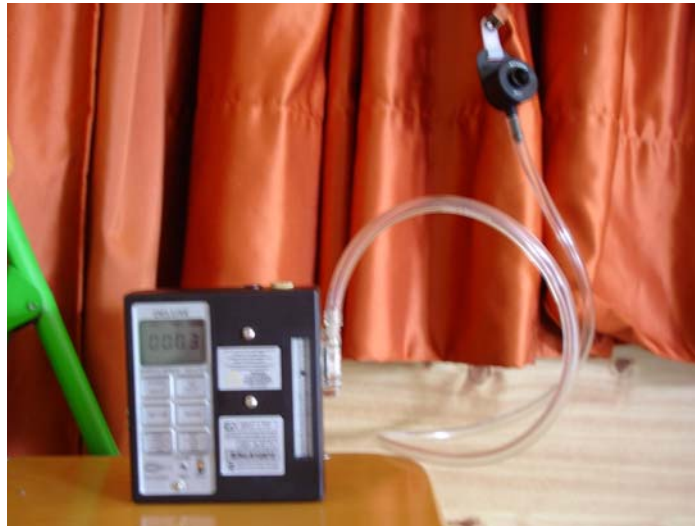
Εικόνα 2.8: Σύστημα αντλίας αέρα με προσαρμοσμένο φίλτρο για τη συλλογή αιωρούμενων σωματιδίων.
