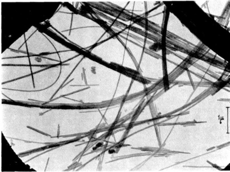
Abb. 1. 875/40. Serpentinastbest. Elektronenoptisch: 9000 : 1; Abbildung: 10 800 : 1.
